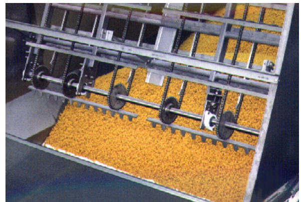
Ensamble de rastrillos de descarga
